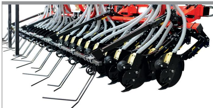
Saatstriegel mit Feder mit Schwalbenschwanz.
