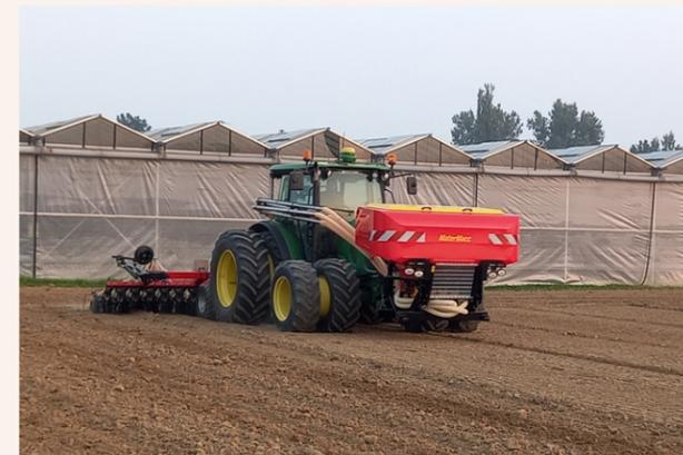
**Pneumatische Drillmaschinen** mit 5 Meter und 6 Meter, Saatgutkapazität von 1800 bis 2200 Liter auf Fronttank. Es handelt sich um dieselbe Drillmaschine wie die MSD ELEKTRO, aber der Behälter ist frontal zum Traktor platziert um eine bessere Gewichtsverteilung und eine bessere Sicht auf die Rampe zu haben.
