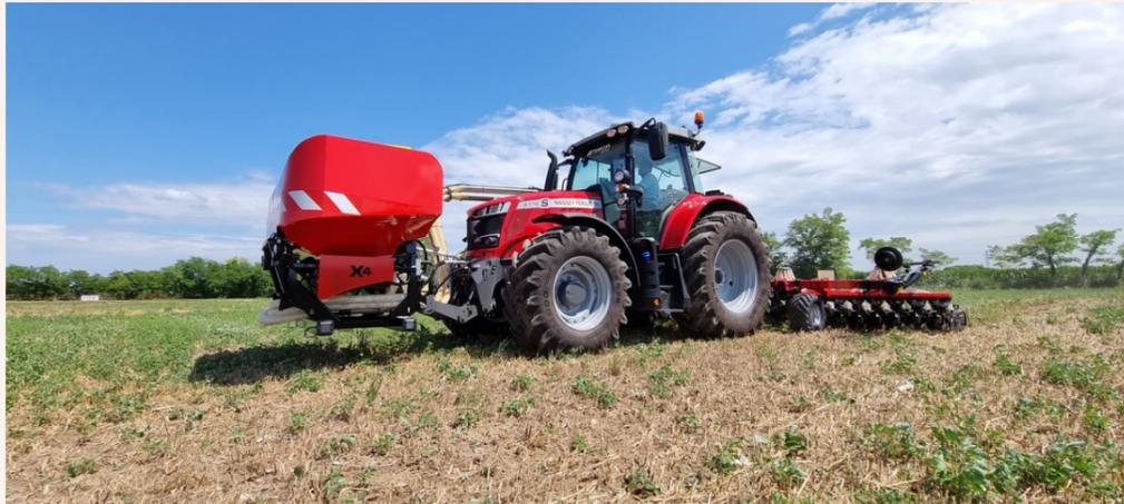
FTC-Sämaschine, Fronttank plus Säbalken mit klappbarem Rahmen
