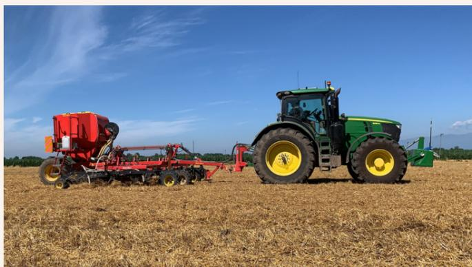
Die Modelle gibt es in 4,5 und 6 Metern mit verschiedenen Möglichkeiten für den Reihenabstand. Der Saatgutbehälter ist zweigeteilt, damit man gleichzeitig säen und düngen kann. Die Maschine wird sogar zur mechanischen Unkrautbekämpfung und zum Verteilen von pelletiertem Dünger eingesetzt.
