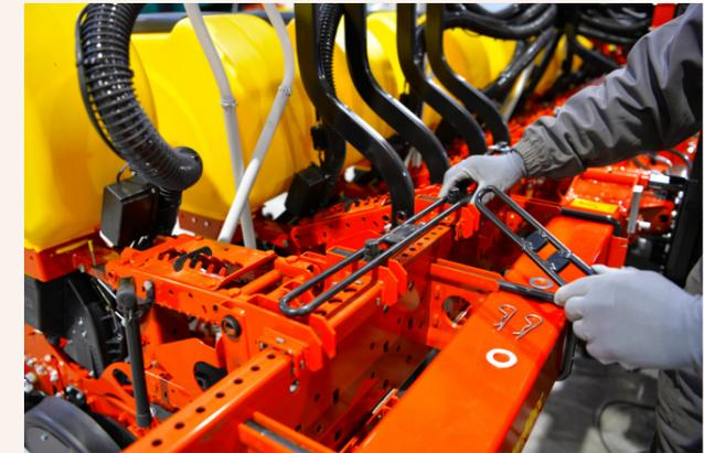
Von einer 12-reihigen Maschine mit 50 cm Abstand, auf einer 8-reihigen mit 75 cm Abstand wird in einer halben Stunde umgestellt. Eine 12-reihige Maschine, die auf 5 Reihen mit 1,5 m Abstand umgestellt wird, ohne etwas zu demontieren ist möglich. Auch verschiedene Reihenabstände auf derselben Maschine sind möglich, fast alles konfigurierbar.
