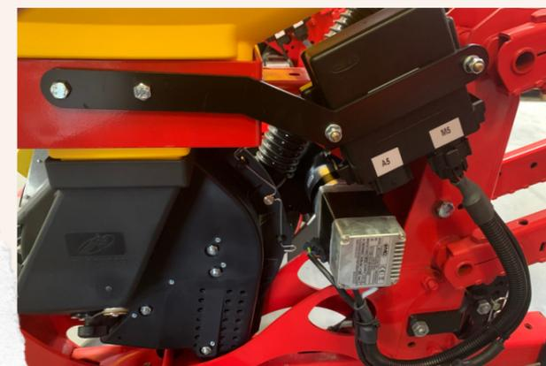
Der gewählte kompakte Elektromotor, ermöglicht die Aussaat auch bei Abständen von 30 cm (bei Verwendung von schmalen Tiefenrädern). Der Motor ist in den Rahmen der Sämaschine untergebracht. Die robuste Kette überträgt den Antrieb auf die MagicSem-Säeinheit.
