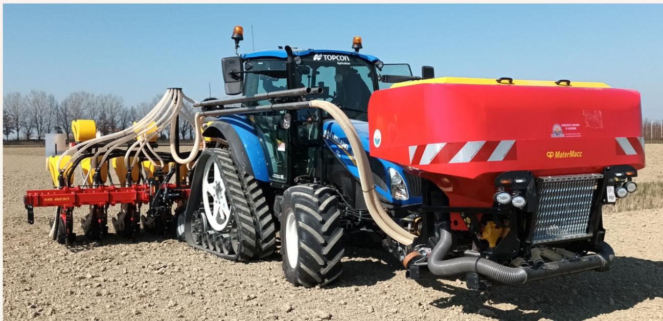
*MS8230 12-reihig elektrisch angetrieben, mit SVA Fronttank*
