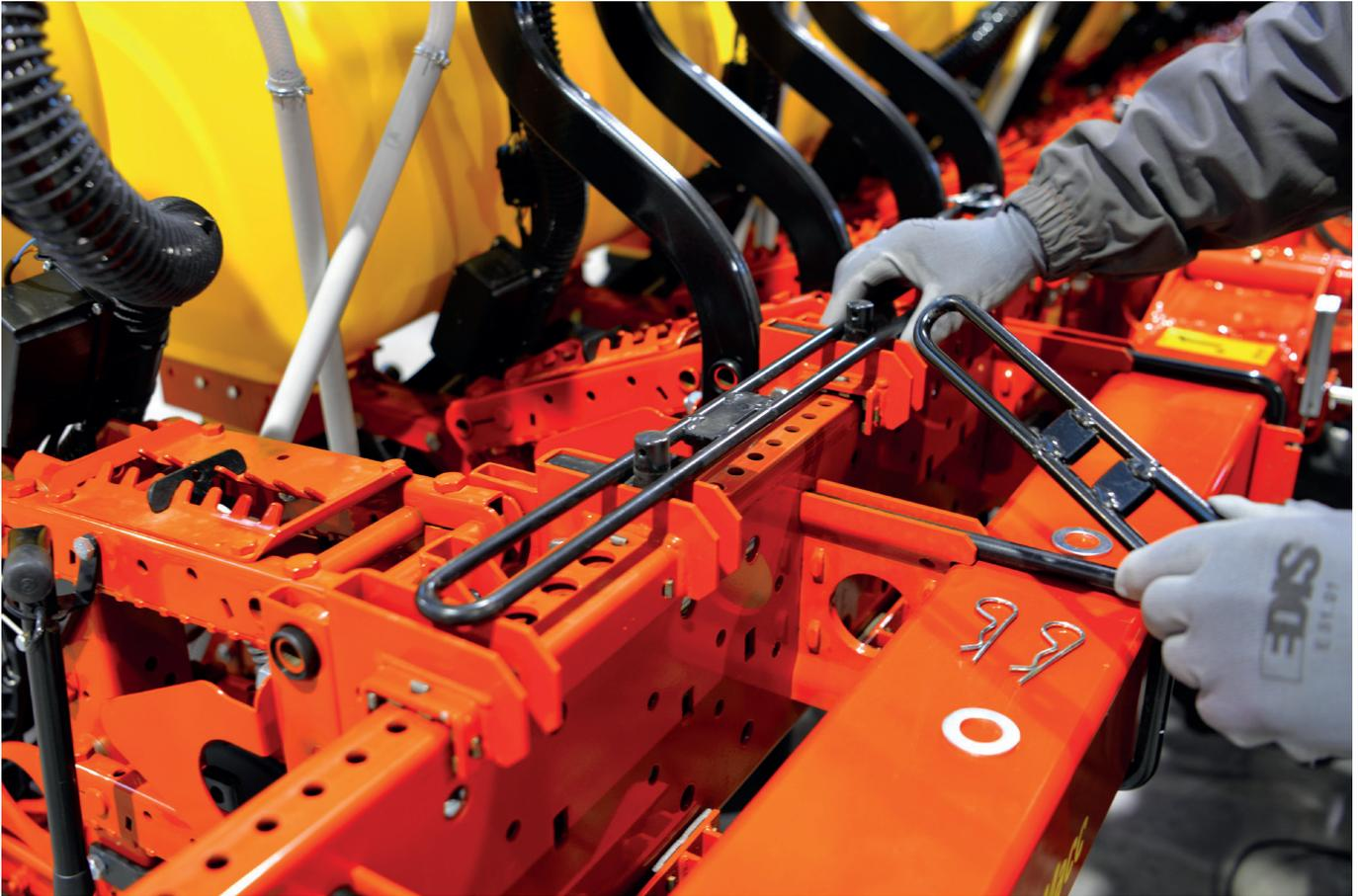
*Easy-Set system: Er ist ein Rahmen, der die Variation des Abstandes zwischen den Reihen in kürzester Zeit ermöglicht: 2 Minuten pro Element. Der Rahmen ist verwendbar sowohl für 4000 als auch für 8000 Elemente.*
